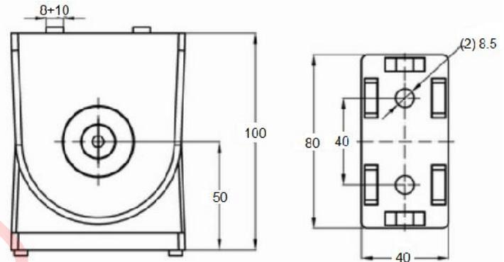
No incluye tornillería, se pide por separado, Use (4x) tornillos socket allen M8x16 para perfil 40 y 40x80
